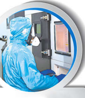
北京三帝科技股份有限公司旗下北京隆成自主研发的激光金属增材3D打印机。
