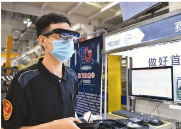
天津海尔洗衣机互联工厂是一个大型智能+5G智慧园区,拥有4条智能总装线、3个智能模块区及3套智能物流系统。工厂还应用了上百项AI+5G等物联网技术,设计并投产配有3000余个传感器的工业互联网柔性生产线。图为天津海尔洗衣机互联工厂内,工作人员利用5G技术进行检验工作。
