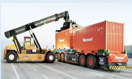
AGV无人驾驶车辆正在集装箱装载
