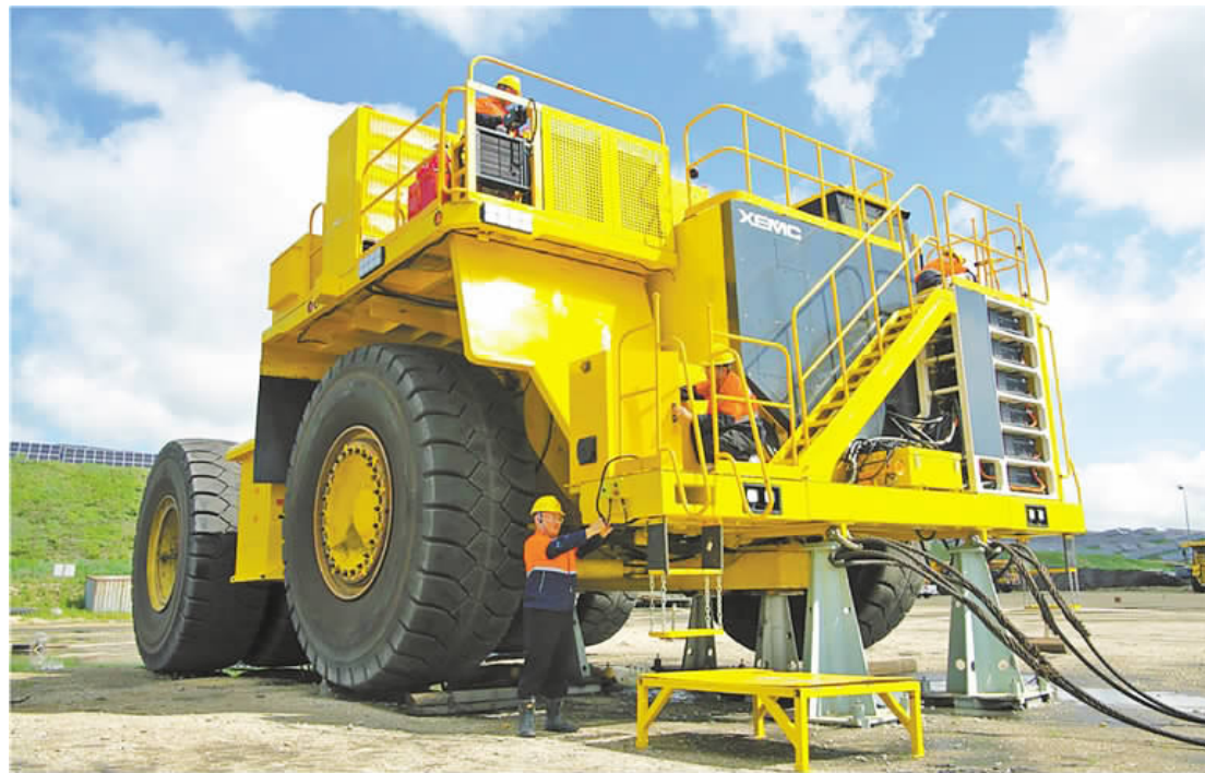
220T纯电动矿车安装中
