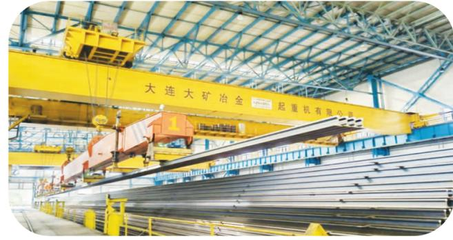
包钢轨梁厂百米钢轨吊车正在吊装钢轨
