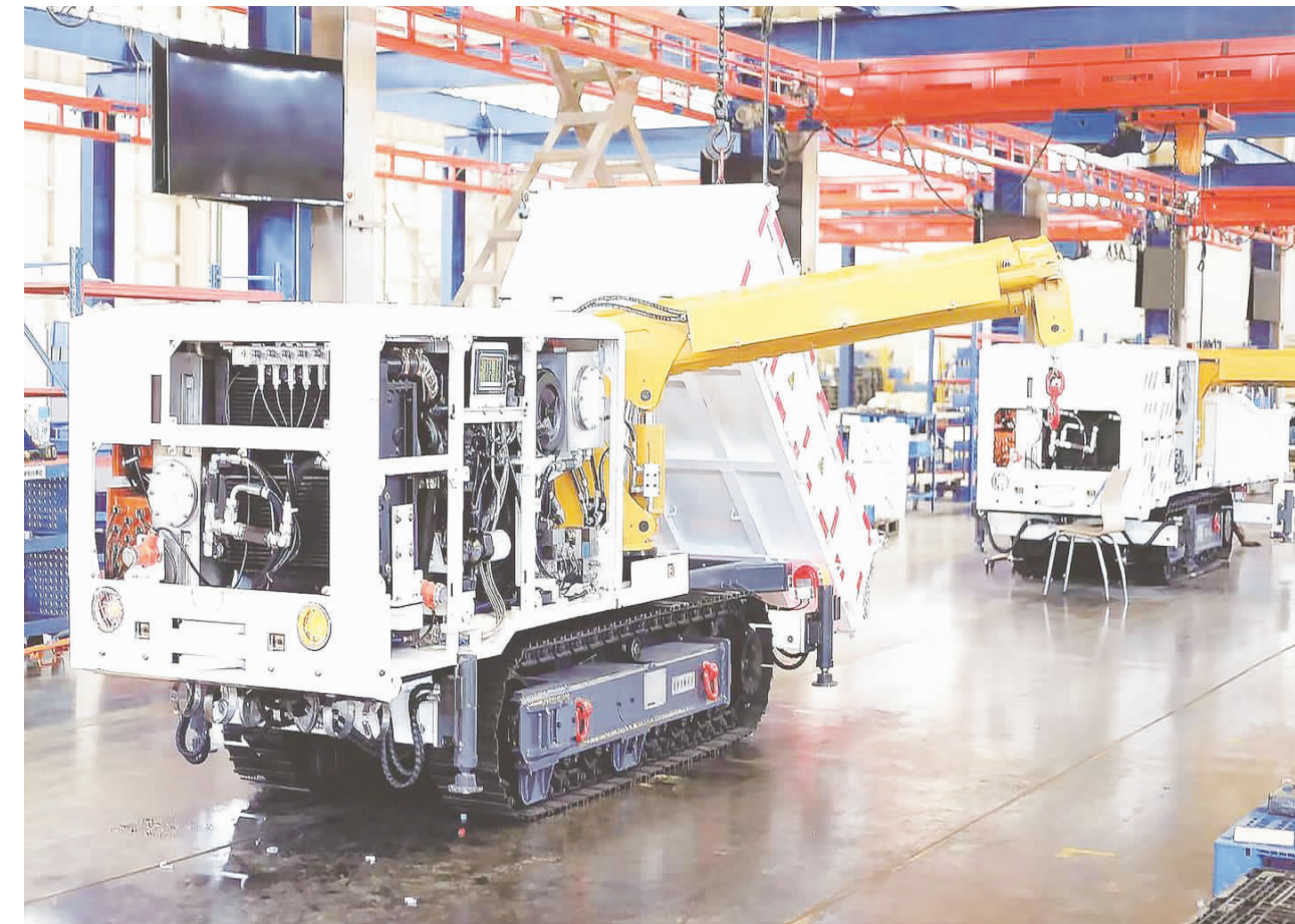
生产线上的矿山自动搬运机器人
